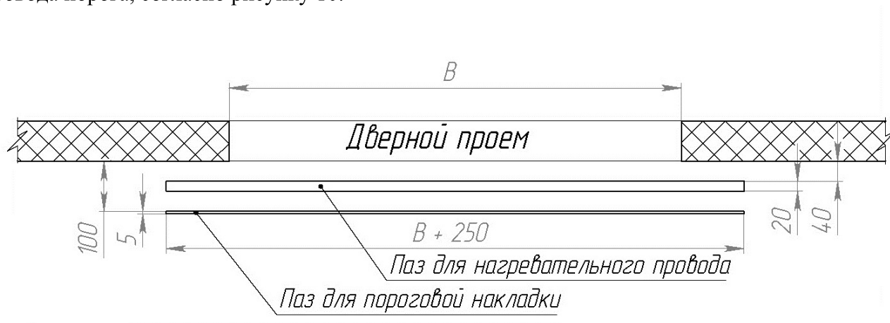
Рисунок 10. Пазы для нагревательного провода и пороговой накладки
